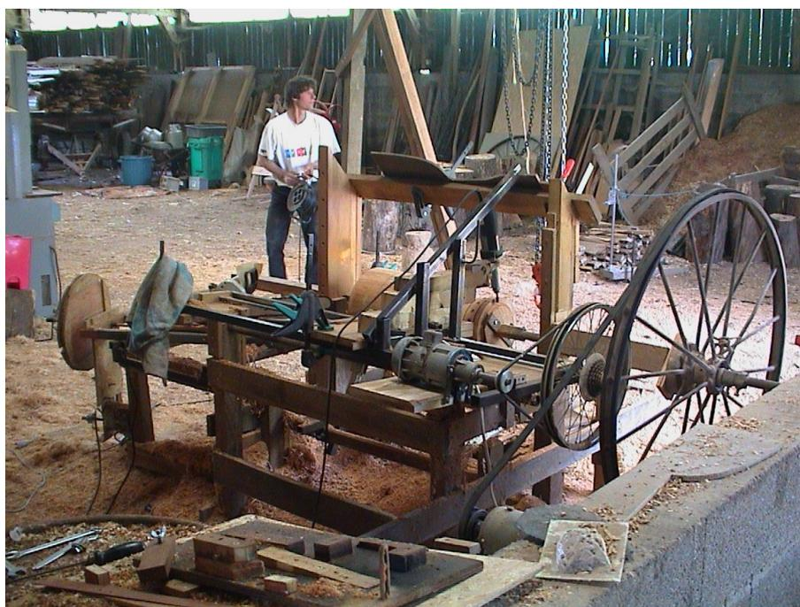
*Pour la forme je fais plein d'essais et ceci de façon assez simple puisque sur le tour la forme du djembé est donné par un gabarit.*
